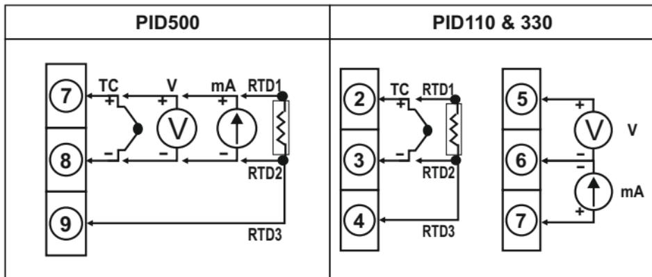
TC - Thermocouple (J, K, T, R, S, C, E, B, N, L, U, W, Platinel II).
